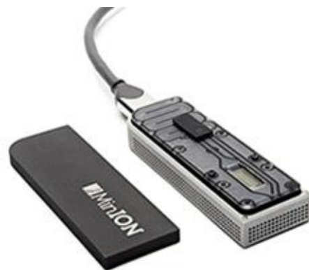
MinION. Dispositivo secuenciador del tamaño de un pendrive que obtiene energía a partir de un puerto USB. Imagen: Oxford Nanopore Technologies .
